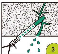
3・特殊注入用ノズルを挿入し、樹脂を注入する。深部まで注入が終わると、樹脂がひび割れから溢れてくる。
