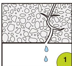
1・コンクリートのひび割れから漏水している状況。
